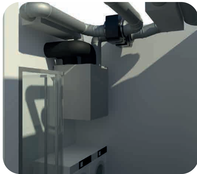
Rekuperační jednotka s napojením HomEvap
